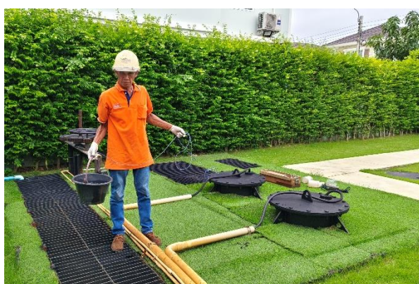
รูปที่ 3-1 การเก็บตัวอย่างน้ำจากระบบบำบัดน้ำเสีย
