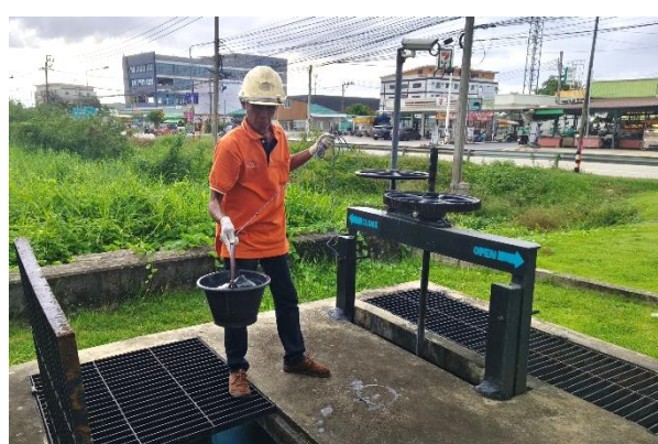
รูปที่ 3-1 การเก็บตัวอย่างน้ำจากระบบบำบัดน้ำเสีย
